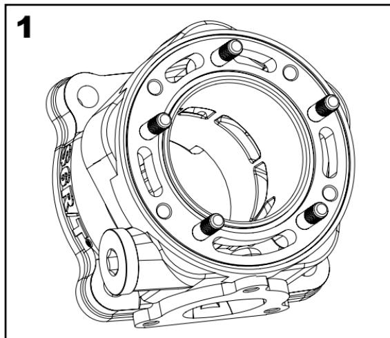
**3.6 Wasseranschlüsse:** Der seitliche Wasseranschluss am Zylinder ist mit der Verschlusschraube und untergelegter Dichtung zu verschließen. Er wird für Minarelli-Motoren nicht verwendet. Der Wasser-
