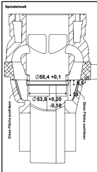
**2.2 Dichtflächen:** Die Dichtflächen des Motorgehäuses müssen in einem einwandfreien Zustand sein. Um einen störungsfreien Betrieb zu gewährleisten, müssen Beschädigungen oder nicht plane Dichtflächen ausgeschlossen werden. Ansonsten kann es zu Beschädigungen an Motorteilen, insbesondere am Zylinder, kommen. Sollte das Motorgehäuse beschädigt sein, ist es zu ersetzen oder von einer Fachwerkstatt überholen zu lassen.
