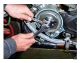
SCREW THE EXTRACTOR FOR YAMAHA IGNITION AND REMOVE THE ROTOR, WITH THE 2 KEYS.
