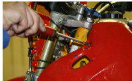
AUSBAU DER RECHTEN SEITLICHEN VERKLEIDUNG
