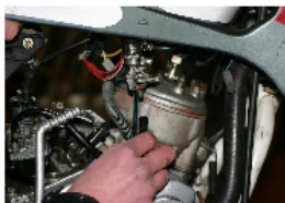
BENZINHAHN ZURDEHN UND BEFESTIGUNGSSCHRAUBEN ENTFERNEN
