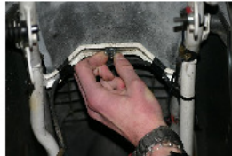
FLÜGELMUTTER UNTER DER SITZBANK ENTFERNEN
