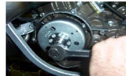
**DEN POLRADABZIEHER DERBI EINSETZEN UND DER ROTOR MIT DEN ENTSPRECHENDEN SCHLÜSSEELN HERAUSNEHMEN**
