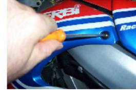
**DIE BEIDEN OBEREN SCHRAUBEN DER RECHTEN UND LINKEN SEITLICHEN VERKLEIDUNGSTEILE DES HEIZKÖRPERS MIT EINEM KREUZSCHRAUBENZIEHER ENTFERNEN.**
