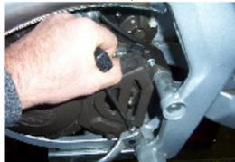
**DIE BEFESTIGUNGSSCHRAUBE DES FUSSSCHALTHEBELS MIT EINEM 10ER SCHLÜSSEL ENTFERNEN, DANN FUSSSCHALTHEBEL ABNEHEMEN**
