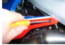
**DIE BEIDEN UNTEREN SCHRAUBEN DER RECHTEN UND LINKEN SEITLICHEN VERKLEIDUNGSTEILE DES HEIZKÖRPERS MIT EINEM KREUZSCHRAUBENZIEHER ENTFERNEN,**
