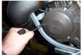
**DIE 3 BEFESTIGUNGSSCHROBEN DES ZÜNDUNGSGEHÄUSES MIT EINEM 8ERSCHLÜSSEL ETFFERNEN**
