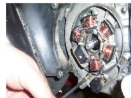
DIE 2 BEFESTIGUNGSSCHRAUBEN DES EMPFÄNGERS MIT EINEM KREUZFÖRMIGEN SCHRAUBENZIEHER ABZULEGEN
