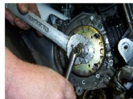
DEN EXTRAKTOR ZU LOKALISIEREN PIAGGIO UND DEN ROTOR MITTELS DER ENTSPRECHENDEN CLÉF ZU EXTRAHIEREN
