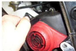
FÜR DIE MODELLE HAT LUFTREFROIDISSMENT, DIE BEFESTIGUNGSSCHRAUBEN DER ZÜNDUNGSSCHUTZHÜLLE MIT EINEM KREUZFÖRMIGEN SCHRAUBENZIEHER ZURÜCKZUZIEHEN UND ES ABZULEGEN
