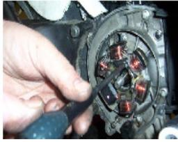
**DIE BEFESTIGUNGSSCHRAUBEN DES STATORS MIT EINEM KREUZFÖRMIGEN SCHRAUBENZIEHER ZURÜCKZUZIEHEN**
