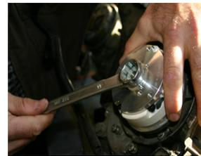
**DEN ROTOR MITTELS DER MUTTER GELIEFERT UND RE ZU DRÜCKEN DIE VERKEILUNG ZUM HOCH TOTEN PUNKT ZU KONTROLLIEREN.**
