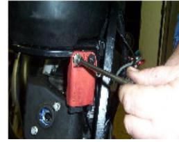
**DIE 2 BEFESTIGUNGSSCHRAUBEN DER SPULE ABZULEGEN HAT HOCHSPANNUNG MIT EINEM SCHLÜSSEL PFEIFE VON 8 UND ES ZURÜCKZUZIEHEN.**
