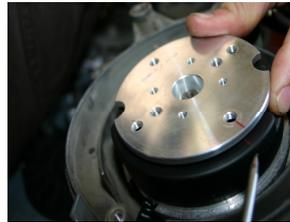
**EIN PENSUM IM KERZENLOCH ZU LOKALISIEREN UND DEN DREHBOHRER ZU DREHEN, UM DEN HOHEN TOTEN MOTOR ODER MEHR ZU LOKALISIEREN UND DEN ROTOR AUF DEM DREHBOHRER ZU SETZEN, INDEM MAN LÄßT DIE 2 BEZUGSPUNKTE ROT DES ROTORS UND DES STATORS IN DER DREHRICHTUNG DES MOTORS ZUSAMMENFALLEN.**
