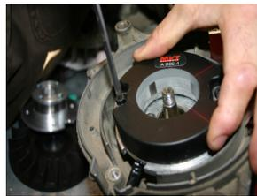
**WIEDERZUGEWINNEN GEHT FADEN AUF DEM URSPRUNGSSTATOR ÜBER, UND ES AUF DIE HÜLLE DER PREMIUMZÜNDUNG ZU SETZEN, DANN, DIE HÜLLE DURCH DAS LOCH DES GEHÄUSES ÜBERZUGEHEN UND DEN STATOR MITTELS DER 2 SCHRAUBEN VON 5 X 30 MM UND DER GELIEFERTEN SCHEIBEN ZU SCHRAUBEN.**
