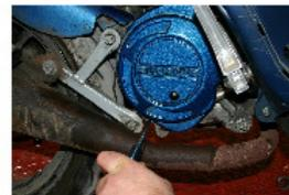
FÜR DIE MODELLE HAT FLÜSSIGES ABKÜHLEN, DIE SCHRAUBEN DER ZÜNDUNGSSCHUTZ HÜLLE MIT EINEM KREUZFÖRMIGEN SCHRAUBENZIEHER ZURÜCKZUZIEHEN.
