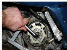
DEN ROTOR IM UMGEKEHRTEN SINN DER DR EHRICHTUNG ZU DREHEN, DAMIT DER KOLBEN IN KONTAKT MIT DEM KOLBENBLOCK DIE MUTTER DES ROTORS MIT EINEM SCHLÜSSEL LÖSEN WIRD, HAT PFEIFE VON 15.
