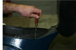
DIE HÖHEREN SCHRAUBEN DER RECHTE UND LINKE DER SCHUTZHÜLLE DES SATTELS MIT EINEM KREUZFÖRMIGEN SCHRAUBENZIEHER UNTER ZURÜCKZUZIEHEN.
