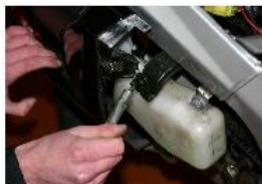
RETIRER LA VIS DE FIXATION DU HAUT DE CARÉNAGE SUPERIEUR GAUCHE A L'AIDE D'UNE CLÉ A PIPE DE 10.
