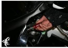
RETIRER LA VIS SUPERIEUR GAUCHE DE LA TÊTE DE FOURCHE A L'AIDE D'UN TOURNEVIS CRUCIFORME.
