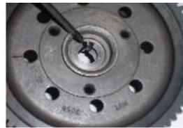
POSITIONNER LA RAINURE "A" SUR LE CLAVETAGE DU VILBREQUIN.
