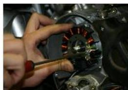
POSITIONNER LE STATOR ET LE SERRER AVEC LES 3 VIS DE 4mm ET UN TOURNEVIS CRUCIFORME.
