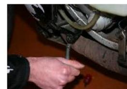
RETIRER LA VIS DE FIXATION DU BAS DE CARENAGE SUPERIEUR GAUCHE A L'AIDE D'UNE CLÉ A PIPE DE 10.
