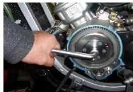
DESSERRER L'ÉCROU A L'AIDE D'UNE CLÉ A PIPE DE 15.
