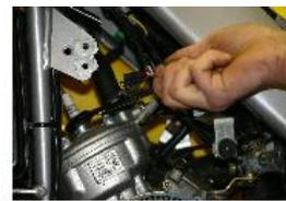
SI VOUS NE POSSEDEZ PAS L'AIR COMPRIMÉ, DÉPOSER LA BOUGIE A L'AIDE D'UNE CLÉ DE 21.
