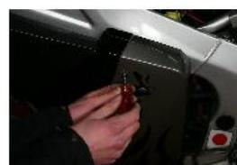
RETIRER LES VIS SUPERIEURES DE CARENAGE GAUCHE A L'AIDE D'UN CRUCIFORME.
