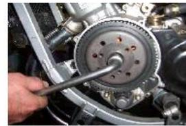
SERRER LE ROTOR A L'AIDE DE L'ÉCROU D'ORIGINE ET D'UNE CLÉ DE 15.
