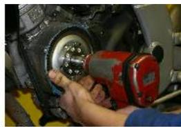
DESSERRER L'ÉCROU DE 15 DU ROTOR A L'AIDE D'UN PISTOLET A AIR COMPRIMÉ.
