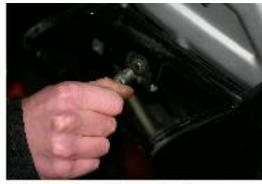
RETIRER LA VIS LATÉRALE DU CARÉNAGE SUPERIEUR A L'AIDE D'UNE CLÉ A PIPE DE 10.
