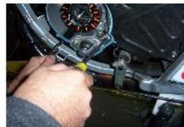
RETIRER LES 2 VIS DE CAPTEUR A L'AIDE D'UN TOURNEVIS CRUCIFORME.
