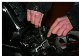
DESSERRER LES 2 VIS INFERIEURES DE FIXATION ARRIERE DU RÉSERVOIR A L'AIDE D'UNE CLÉ A PIPE DE 10.
