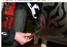
RETIRER LES VIS INFERIEURES DE CARENAGE GAUCHE A L'AIDE D'UN CRUCIFORME.
