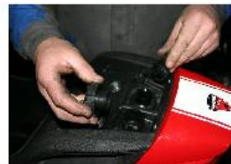
RETIRER LES BOUCHONS DES RÉSERVOIRS D'HUILE ET D'ESSENCE.
