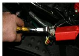
COUPER LA FIXATION PLASTIQUE ET RETIRER LE CONNECTEUR DU STATOR ET DÉPOSER LA BOBINE.
