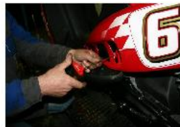
RETIRER LES VIS DE FIXATION DROIT ET GAUCHE DU CACHE DESSOUS DE SELLE AVEC UNE CLÉ ALLEN DE 5.
