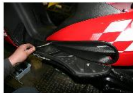
RETIRER LES VIS DES CACHES ENTRÉE D'AIR DROIT ET GAUCHE AVEC UN TOURNEVIS CRUCIFORME ET LES DÉPOSER.
