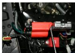
RETIRER LES 2 VIS DE LA BOBINE HAUTE TENSION AVEC UNE CLÉ ALLEN DE 5, RETIRE LE CONNECTEUR ETANCHE.
