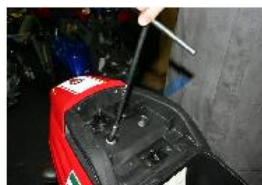
AVEC UNE CLÉ A PIPE DE 10, RETIRER LES 2 VIS ARRIÈRES DU COFFRE.
