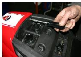
RETIRER LES VIS DE FIXATION ARRIÈRE DU CACHE DESSOUS DE SELLE AVEC UN TOURNEVIS CRUCIFORME.
