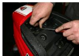
RETIRER LES JOINTS D'ÉTANCHEITÉ ENTRE LE COFFRE ET LES RÉSERVOIRS D'HUILE ET D'ESSENCE.
