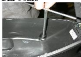
AVEC UNE CLÉ A PIPE DE 10, RETIRER LES 2 VIS AVANTS DU COFFRE.
