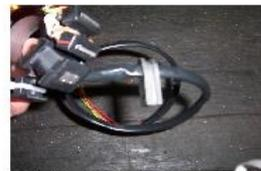
RÉCUPÉRER LE PASSE FIL DU STATOR D'ORIGINE ET LE POSITIONNER DANS LE BON SENS SUR LA GAINÉ DU STATOR MILLÉNIUM.
