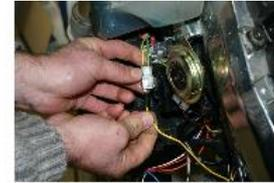
BRANCHER LE FIL JAUNE DU STATOR MILLÉNIUM AVEC LE CABLE JAUNE DU CONNECTEUR 2 VOIES DU FAISCEAU D'ORIGINE.
