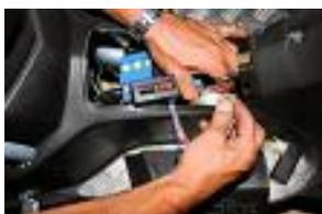
**Positionner le diagramme MVT a la place du CDI d'origine et brancher le câble bleu du diagramme a la masse pour obtenir la régulation du véhicule a 45km/h.**
