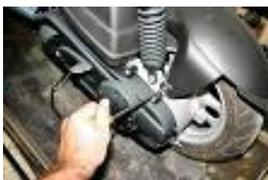
Dépose de la vis gauche du garde boue arrière.
