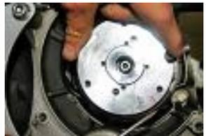
**Positionner une pige de calage dans le trou de la bougie et tourner le vilebrequin à 0.35mm avant le point mort haut et placer le rotor sur le vilebrequin en faisant coïncider les 2 repères rouge du stator et du rotor.**
