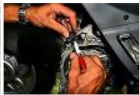
**Couper sur l'arrière le passe fil d'origine et le récupérer et déposer le stator en retirant le faisceau jusqu'à la connectique préalablement débranchée.**
