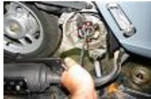
**Dépose des 2 vis de fixation du stator.**
