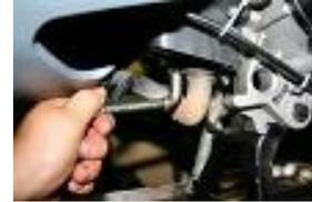
Retirer les 2 écrous de fixation d'échappement au cylindre avec une clé à pipe de 10.
