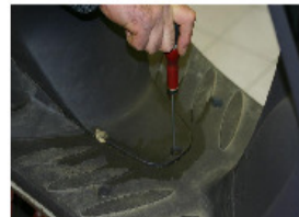
DIE HÖHERE SCHRAUBE DER CACHE BATTERIE MITTELS EINES SCHLÜSSELS TORX VON 20 ODER EINES FLACHEN SCHRAUBENZIEHERS ZURÜCKZUZIEHEN.
