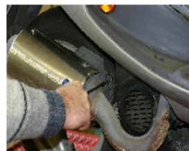
STELLT VON DER HÖHEREN SCHRAUBE (BTR 8) DER BEFESTIGUNG DES ECHAPEMENT-TOPFES AM GEHÄUSE.
