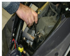
DIE BEFESTIGUNGSSCHRAUBEN TOPF AM ZYLINDER MITTELS EINER BOHRRATSCHEN UND HÜLSE VON 10 ZU LÖSEN UND ABZULEGEN.
