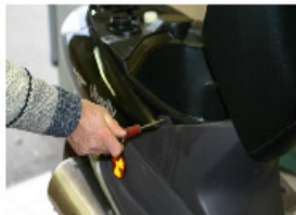
DIE 2 SUPERIEURESSCHRAUBEN DER SCHUTZHÜLLE BATTERIE MITTELS EINES SCHLÜSSELS TORX VON 20 ODER EINES FLACHEN SCHRAUBENZIEHERS ZURÜCKZUZIEHEN.
