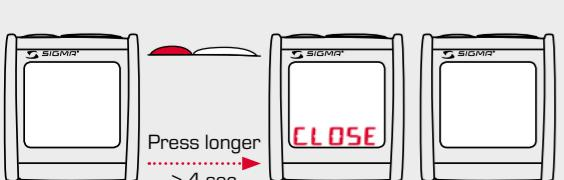
Reset Ride Time / Fahrzeit zurücksetzen / Remettre le temps à zéro
