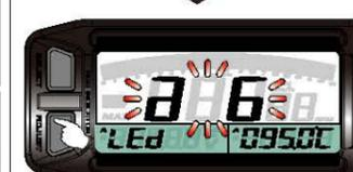
● Bsp. Die Einstellung der Temperatur-Alarmlampe A (Blau) wurde von 90 °C auf 95 °C geändert.
