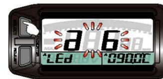
● Drücken Sie die **Auswahl**taste, um zum Einstellbildschirm für die Temperaturalarm-Lampe (Blau) zu gelangen.
