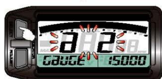
● Drücken Sie die **Auswahl**taste, um zum Einstellbildschirm für Niveau Drehzahlmesser zu gelangen.
