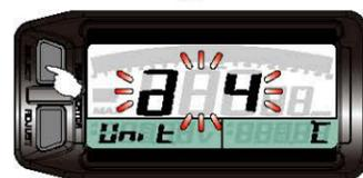
● Drücken Sie die **Auswahl**taste, um auf den Bildschirm zur Einstellung der Einheit für die Temperatur zu gelangen.
